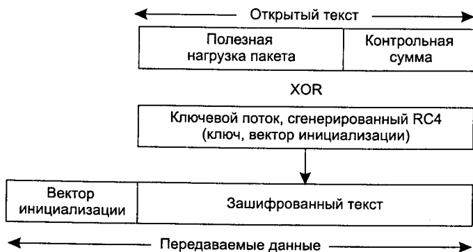
Рис. 8.27. Шифрация пакета с использованием WEP
