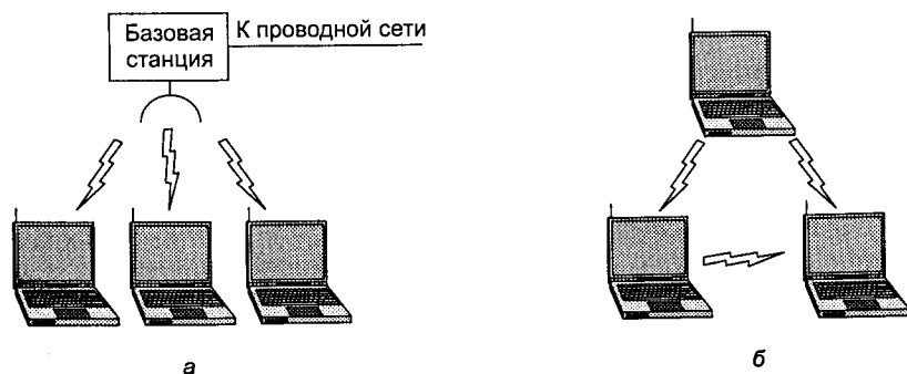
Рис. 1.31. Беспроводная сеть с базовой станцией (а); специальная сеть (б)
