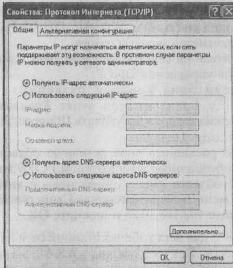
Рис. 8.8. Назначение автоматического получения IP-адреса
